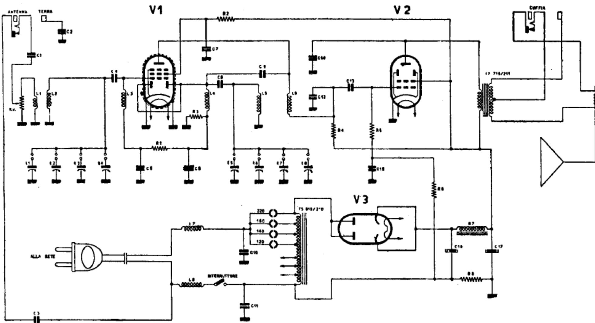
PHONOLA (S. A. FIMI). — Mod. 303. — Ricevitore senza condensatori variabili e senza quadrante di sintonia, con quattro bottoni per quattro emittenti. — Media frequenza: 470 kHz. — Potenza d'uscita: 2 W. (V. valori alla pagina seguente).
